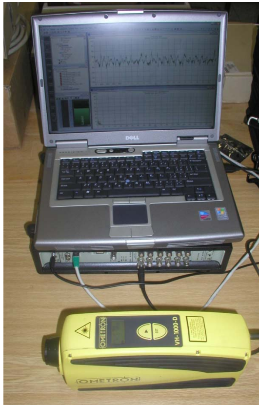
Laserový vibrometr Brüel & Kjær 8338 a jeho nastavení
